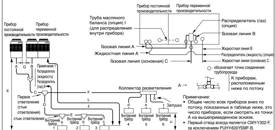
Примечание 1: В используется только для транспортировки жидкости, потому что он встроен в прибор переменной производительности. Настройте прибор постоянной производительности и прибор переменной производительности в соответствии с размером G, приведенным на рис. выше (G = 0,01 м).
