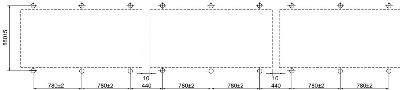
Για συλλογική εγκατάσταση εξασφαλίστε κενό 10 mm ανάμεσα στις μονάδες.
