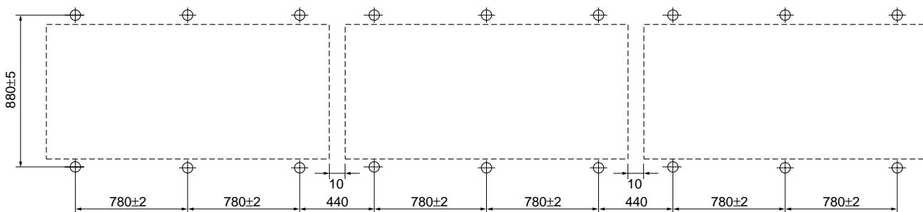
При совместной установке предусмотрите 10мм зазор между приборами.
