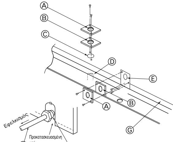
Για να αποφύγετε τον εξωτερικό εφελκυσμό στο τμήμα σύνδεσης των καλωδίων του πλακίδιου ακροδεκτών ηλεκτρικής τροφοδοσίας, χρησιμοποιήστε παρέμβυσμα απόσβεσης τύπου PG ή παρόμοιο.
