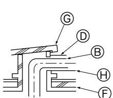
Проникающая часть на пожарозащитном перекрытии и ограничивающей стене
