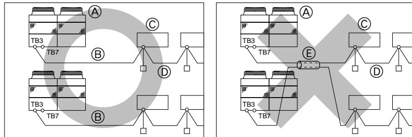
TB3: Tablero de terminales de la línea de transmisión, TB7: Tablero de terminales de la línea de control central.
