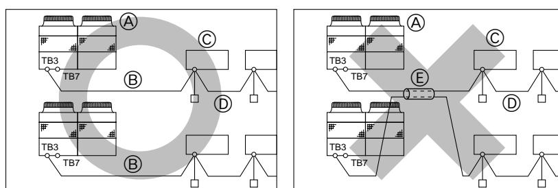
TB3: Πίνακας τερματικών για καλωδίωση μετάδοσης, TB7: Πίνακας τερματικών για κεντρικό έλεγχο
