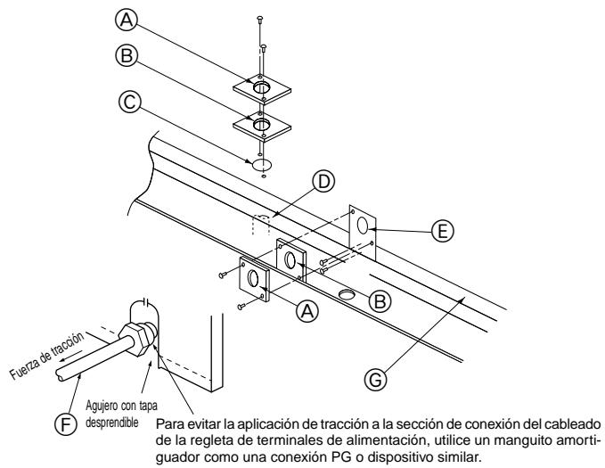
Para evitar la aplicación de tracción a la sección de conexión del cableado de la regleta de terminales de alimentación, utilice un manguito amortiguador como una conexión PG o dispositivo similar.
