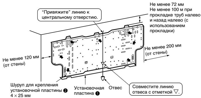
Для предотвращения вибрации установочной пластины обязательно зафиксируйте ее в отверстиях, помеченных стрелками ↑.
