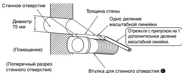
Обязательно используйте втулку для стенового отверстия ③ в целях предотвращения контакта проводов соединения наружного прибора с металлическими деталями стенового перекрытия, а также для предотвращения повреждения деталей крысами, если стена полая.
