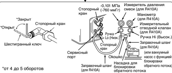
Быстро снимите измерительный отводной клапан с сервисного порта стопорного крана.
