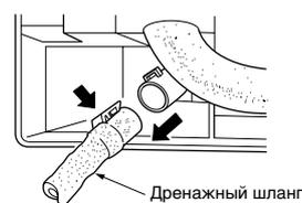
**3 Вставьте дренажный колпачок в секцию задней части внутреннего прибора, к которой должен крепиться дренажный шланг.**
