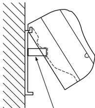
Надежно закрепите комплект прокладок в вогнутой части ребра, проследив за правильностью ее ориентации, как показано на рисунке справа.
