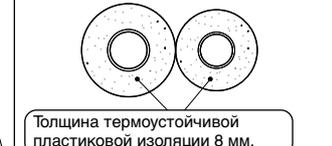
Толщина термоустойчивой пластиковой изоляции 8 мм.
