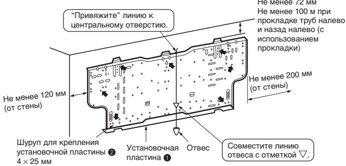
Для предотвращения вибрации установочной пластины обязательно зафиксируйте ее в отверстиях, помеченных стрелками ↑.
