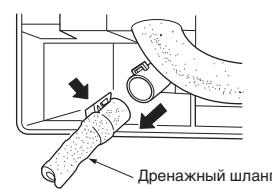
**3 Вставьте дренажный колпачок в секцию задней части внутреннего прибора, к которой должен крепиться дренажный шланг.**
