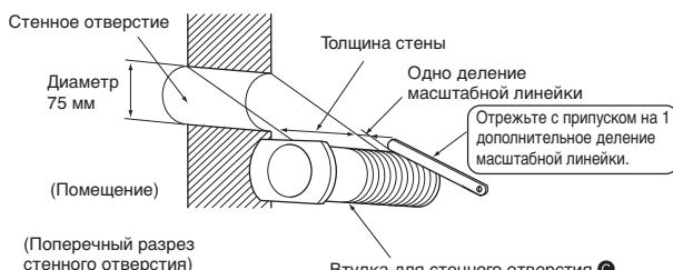
Обязательно используйте втулку для стенного отверстия ④ в целях предотвращения контакта проводов соединения наружного прибора с металлическими деталями стенного перекрытия, а также для предотвращения повреждения деталей крысами, если стена полая.
