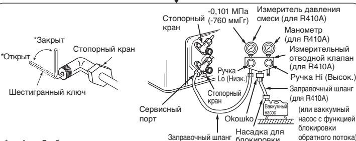
Быстро снимите измерительный отводной клапан с сервисного порта стопорного крана.
