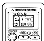
La SPIA DI FUNZIONAMENTO si accende indipendentemente da quanto visualizzato sul display del telecomando.
