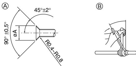
(A) Dimensões do corte de afunilamento
