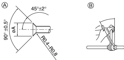
(A) Abmessungen der Aufweitungsschnitte
