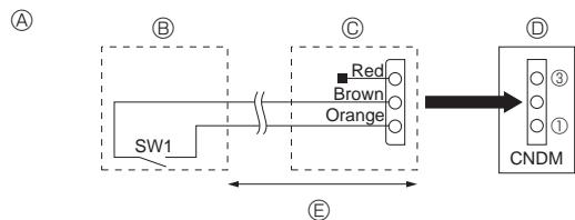
Ⓐ Beispiel eines Schaltplans (Lärmschutzmodus)
