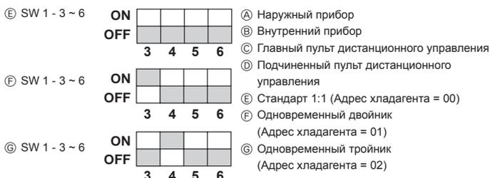
\* Установите адрес хладагента, используя ДИП-переключатель на наружном приборе.
