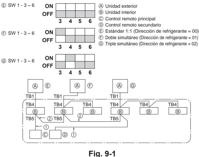
\* Ajuste la dirección de refrigerante utilizando el interruptor DIP de la unidad exterior.
