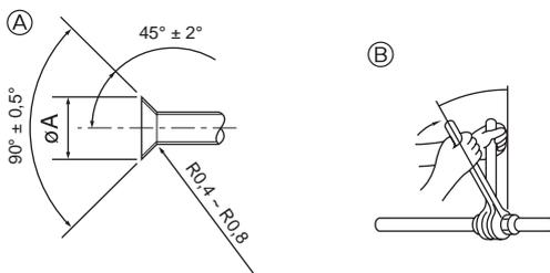
Ⓐ Dimensões do corte de afunilamento
