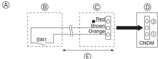
Ⓐ Παράδειγμα διαγράμματος κυκλώματος (λειτουργία με χαμηλότερα επίπεδα θορύβου)
