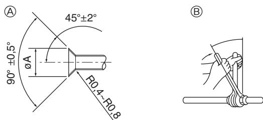
(A) Abmessungen der Aufweitungsschnitte
