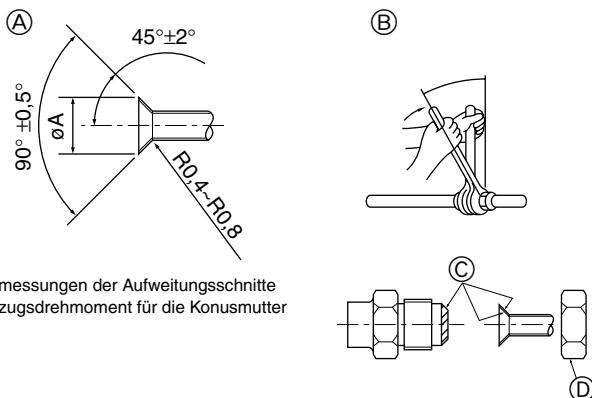
Ⓐ Abmessungen der Aufweitungsschnitte
