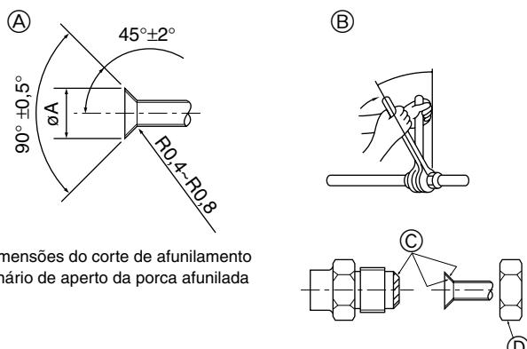
Ⓐ Dimensões do corte de afunilamento
