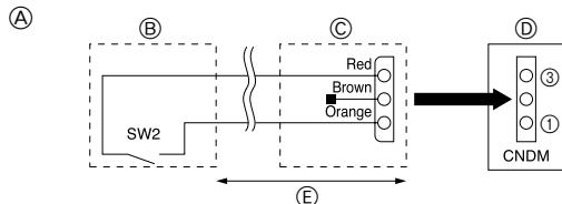
Ⓐ Παράδειγμα διαγράμματος κυκλώματος (λειτουργια ρυθμισης)
