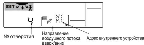
Переключите на адрес следующего устройства с помощью кнопки установки температуры ⑤.
