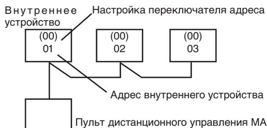
Если настройка переключателя адреса равна "00", адрес внутреннего устройства присваивается автоматически
