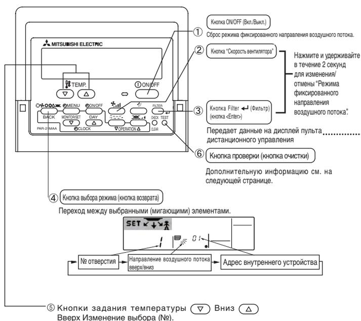
■ Нажатие кнопки с мигающим адресом внутреннего устройства или номером выпускного отверстия...
