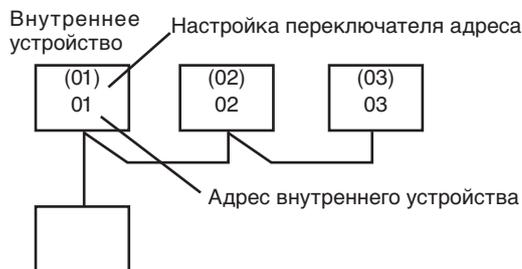
Если настройка переключателя адреса отличается от "00", настройка переключателя адреса совпадает с адресом внутреннего устройства.
