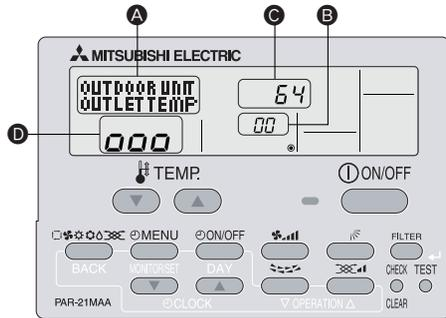
Al utilizar el modo de mantenimiento, puede visualizar distintos tipos de datos de mantenimiento en el controlador remoto, como la temperatura del intercambiador de calor y el consumo de corriente del compresor para las unidades interiores y exterior. Esta función se puede utilizar independientemente de si el aire acondicionado está funcionando o no.
