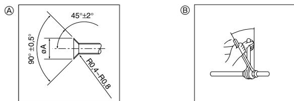
Påfør kølemaskineolie på hele det koniske sædes overflade.
