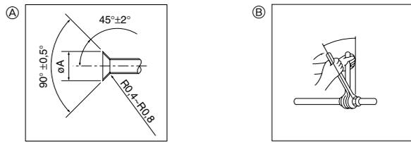
Auf die gesamte Fläche der Aufweitung Kältemittelöl auftragen.
