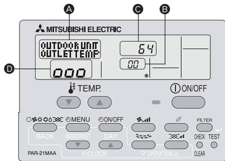
In de onderhoudsstand kunt u van de binnen- en buitenapparaten allerlei onderhoudsgegevens in de afstandsbediening zichtbaar maken, zoals de temperatuur van de warmtewisselaar en het stroomverbruik van de compressor.
