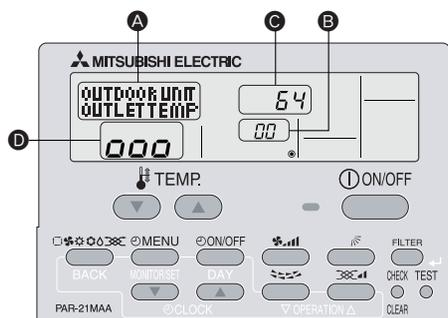
I underhållsläget kan du visa olika typer av underhållsdata på fjärrkontrollen, t.ex. värmeväxlarens temperatur och kompressorns strömförbrukning för inom- och utomhusenheterna.
