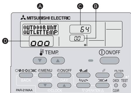
A l'aide du mode d'entretien, il est possible d'afficher plusieurs types de données d'entretien sur la commande à distance, telles que la température de l'échangeur thermique et la consommation électrique du compresseur pour les appareils intérieur et extérieur. Cette fonction peut être utilisée que le climatiseur fonctionne ou non. En fonctionnement, les données peuvent être vérifiées pendant le fonctionnement normal ou le fonctionnement stable en mode d'entretien.
