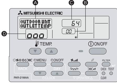
Bakım modunu kullanarak, iç ve dış ünite ısı deęiřtiricisi sıcaklığı ve kompresör akım tüketimi gibi çeřitli bakım bilgilerini uzaktan kumanda ünitesinde görüntüleyebilirsiniz. Bu fonksiyon klima ünitesi çalışsa da çalışmasa da kullanılabilir.
