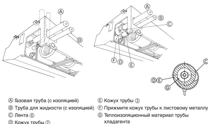
А Газовая труба (с изоляцией)      Е Кожух трубы ③
