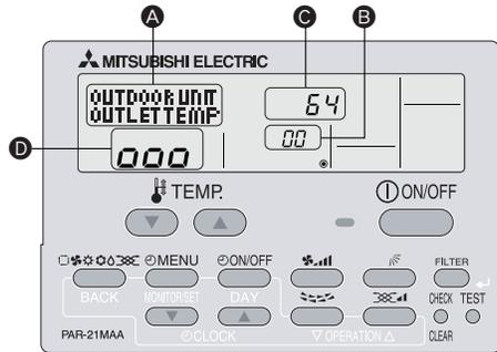
Im Wartungsmodus können Sie viele Arten von Wartungsdaten auf der Fernbedienung, wie etwa Temperatur des Wärmetauschers und Stromverbrauch des Kompressors für die Innen- und Außenanlagen, anzeigen.
