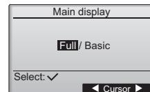
**Not:** Bu ayar sadece Main display içindir. Basic modda, zamanlayıcının kontrol durumunu gösteren simgeler ve ayarların programlanması ekranда gösterilmeyecektir. Pervane, hava deliği ve havalandırma ayarları veya oda sıcaklığının her ikisi de görünmeyecektir.
