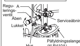
Ved montering af reguleringssventilen på serviceåbningen, kan ventilindsatsen blive deformet eller løsne sig, hvis der bruges for højt tryk. Dette kan forårsage en gaslækage.
