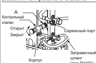
Если при креплении контрольного клапана к сервисному порту прилагать чрезмерное давление, сердечник клапана может деформироваться или открутиться. Это может привести к утечке газа.
