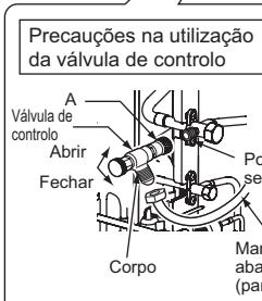
Quando instalar a válvula de controlo na porta de serviço, a chapeleta da válvula pode deformar-se ou afrouxar-se se for aplicada demasiada pressão. Isto pode provocar fuga de gás. Quando instalar a válvula de controlo na porta de serviço, certifique-se de que a chapeleta da válvula está na posição fechada e, em seguida, aperte a peça A. Não aperte a peça A nem rode o corpo quando a chapeleta da válvula estiver na posição aberta.
