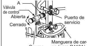
Al conectar la válvula de control al puerto de servicio, la pieza interior de la válvula podría deformarse o soltarse si se aplica demasiada presión. Esto podría provocar fugas de gas.
