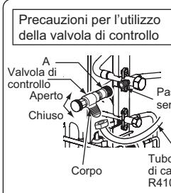
Al momento del fissaggio della valvola di controllo al passaggio di servizio, lo spillo della valvola può deformarsi o allentarsi nel caso venga esercitata una pressione eccessiva. Ciò può causare perdite di gas.
