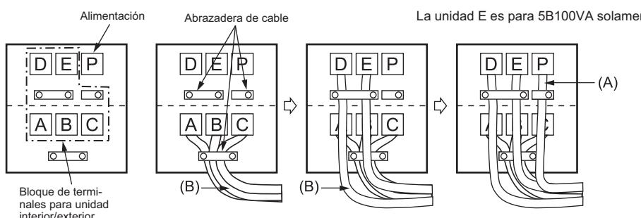
Cable de conexión interior/exterior
