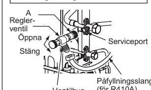
Vid anslutning av reglerventilen till serviceporten kan ventilinsatsen deformeras eller lossna om för högt tryck ansätts. Detta kan orsaka gasläckage.
