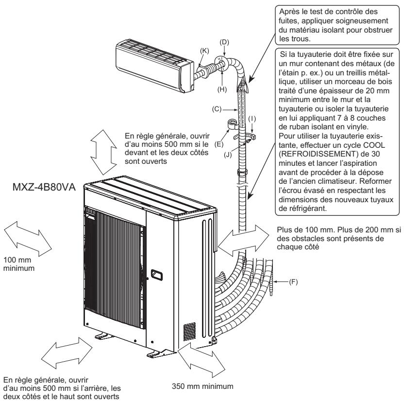
Ces appareils doivent être installés par des entrepreneurs agréés conformément aux réglementations locales en vigueur.
