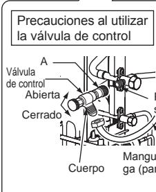
Al conectar la válvula de control al puerto de servicio, la pieza interior de la válvula podría deformarse o soltarse si se aplica demasiada presión. Esto podría provocar fugas de gas.
