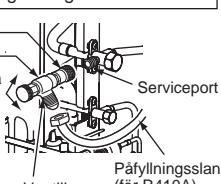
Vid anslutning av reglerventilen till serviceporten kan ventilinsatsen deformeras eller lossna om för högt tryck ansätts. Detta kan orsaka gasläckage.
