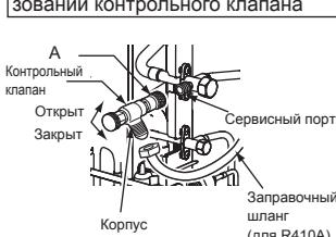
Если при креплении контрольного клапана к сервисному порту прилагать чрезмерное давление, сердечник клапана может деформироваться или открутиться. Это может привести к утечке газа.
