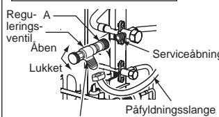
Ved montering af reguleringsventilen på serviceåbningen, kan ventilindsatsen blive deformert eller løsne sig, hvis der bruges for højt tryk. Dette kan forårsage en gaslækage.
