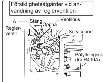
Vid anslutning av reglerventilen till serviceporten kan ventilinsatsen deformeras eller lossna om för högt tryck ansätts. Detta kan orsaka gasläckage.
