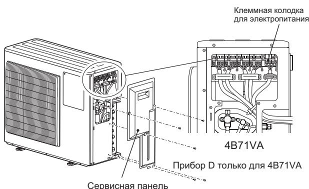
Провод соединения внутреннего/наружного приборов
