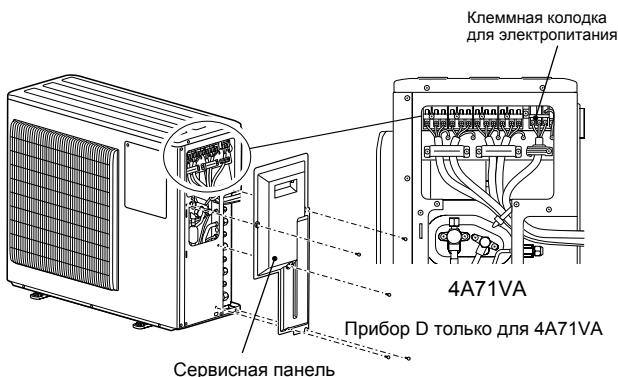
Провод соединения внутреннего/наружного приборов
