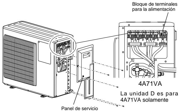
Cable de conexión interior/exterior
