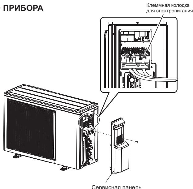
Провод соединения внутреннего/наружного приборов
