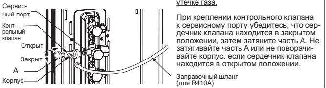
При креплении контрольного клапана к сервисному порту убедитесь, что сердечник клапана находится в закрытом положении, затем затяните часть A. Не затягивайте корпус, если сердечник клапана находится в открытом положении.
