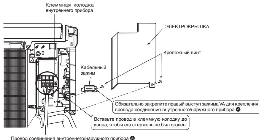
Провод соединения внутреннего/наружного прибора A
