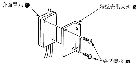
2 使用2個安裝螺絲 ④ 將單元安裝到柱子或牆壁上。
