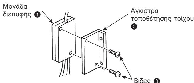
Τοποθετήστε τη μονάδα σε μια κολώνα ή τοίχο χρησιμοποιώντας 2 βίδες ③.
