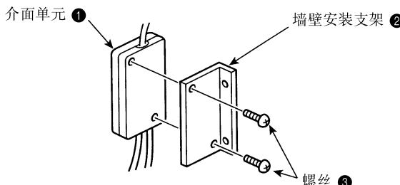
2 使用2颗螺丝③将单元安装到柱子或墙壁上。
