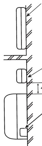
Wenn die Schnittstelleneinheit ① über einem Innengerät montiert wird, sollte sie 40 mm oder weiter vom Gerät entfernt sein, so dass die Deckengitter entfernt werden können.
