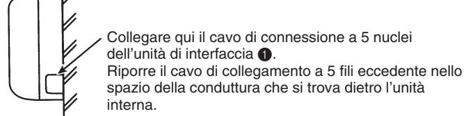
Collegare qui il cavo di connessione a 5 nuclei dell'unità di interfaccia ①.
