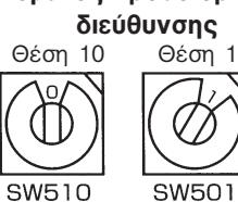
To SW510 ρυθμίζει τη θέση 10 της διεύθυνσης και το SW501 ορίζει τη θέση 1 της διεύθυνσης. Για παράδειγμα, για να ορίσετε μια μονάδα στη διεύθυνση 25, ορίστε το SW510 στο "2" και το SW501 στο "5."
