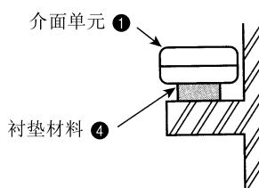
在天花板或墙壁内部安装界面单元①时，安装一个检修门以便于维修。
