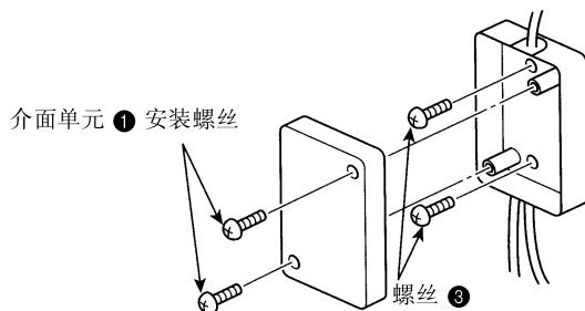
\* 当使用衬垫材料④安装界面单元①时，确保安装在不会跌落的位置上。
