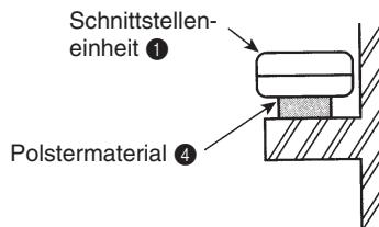
Bei Montage der Schnittstelleneinheit ① in eine Zimmerdecke oder eine Wand installieren Sie bitte zur Erleichterung der Wartung eine Zugangstür.
