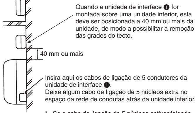
Quando a unidade de interface ① for montada sobre uma unidade interior, esta deve ser posicionada a 40 mm ou mais da unidade, de modo a possibilitar a remoção das grades do tecto.
