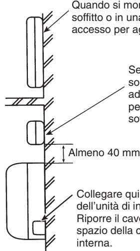
Se si monta l'unità di interfaccia ① al di sopra di un'unità interna, occorre collocarla ad almeno 40 mm di distanza da tale unità per consentire la rimozione delle griglie del soffitto.
