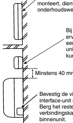
Bij montage boven een binnenunit dient u ervoor te zorgen dat de interface-unit ① op een afstand van minstens 40 mm van de unit wordt geplaatst, zodat plafondroosters kunnen worden verwijderd.
