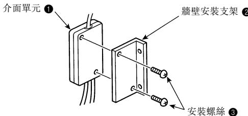
2 使用2個安裝螺絲 ③ 將單元安裝到柱子或牆壁上。
