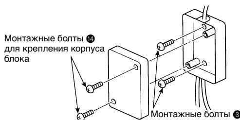
\* Исключите возможность падения при монтаже блока платы ① с помощью амортизационного материала ④.
