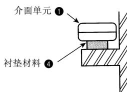
在天花板或墙壁内部安装介面单元 ① 时，安装一个检修门以便于维修。
