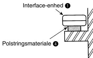
Ved montering af interface-enheten ① inde i et loft eller en væg, skal der installeres en adgangsslug for at muliggøre vedligeholdelse.
