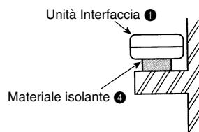
Quando si monta l'unità interfaccia ① incassata nel soffitto o in una parete, installare uno sportello di accesso per agevolare la manutenzione.
