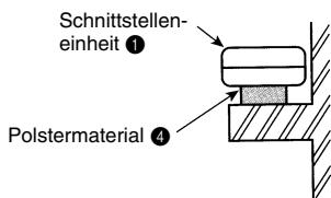
Bei Montage der Schnittstelleneinheit ① in eine Zimmerdecke oder eine Wand installieren Sie bitte zur Erleichterung der Wartung eine Zugangsstür.
