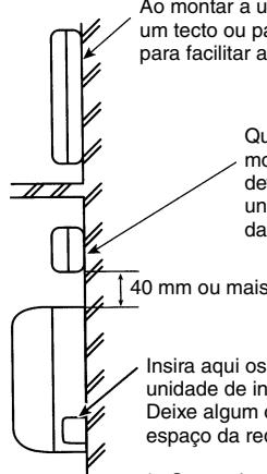
Quando a unidade de interface ① for montada sobre uma unidade interior, esta deve ser posicionada a 40 mm ou mais da unidade, de modo a possibilitar a remoção das grades do tecto.
