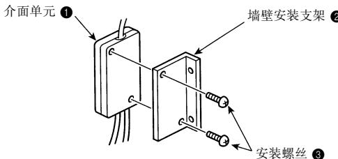
2 使用2个安装螺丝 ③ 将单元安装到柱子或墙壁上。
