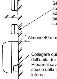
Se si monta l'unità di interfaccia ① al di sopra di un'unità interna, occorre collocarla ad almeno 40 mm di distanza da tale unità per consentire la rimozione delle griglie del soffitto.
