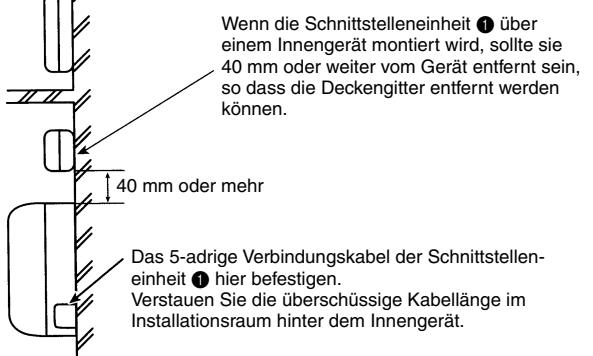
Das 5-adrige Verbindungskabel der Schnittstelleneinheit ① hier befestigen.
