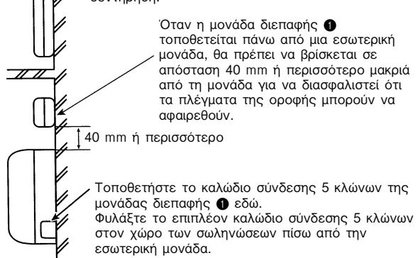
\* Εάν το καλώδιο σύνδεσης 5 κλώνων είναι χαλαρό, χρησιμοποιήστε έναν σύνδεσμο ⑪ για να το κρατήσετε στη θέση του.
