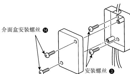
\* 当使用衬垫材料 ④ 安装介面单元 ① 时，确保安装在不会跌落的位置上。
