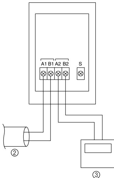
**Wenn die Anschlußleitungen **A** kreuzverdrahtet sind**
