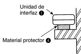
Si va a montar la unidad de interfaz ① empotrada en un techo o pared, instale una puerta de acceso para facilitar el mantenimiento.
