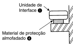
Ao montar a unidade de interface ① no interior de um tecto ou parede, instale uma porta de acesso para facilitar a manutenção.
