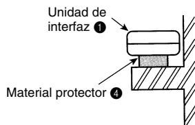
Si va a montar la unidad de interfaz ① empotrada en un techo o pared, instale una puerta de acceso para facilitar el mantenimiento.
