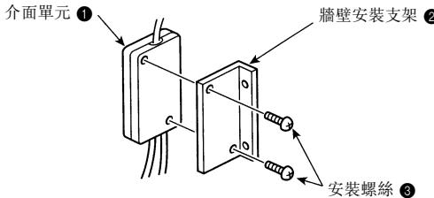
2 使用2個安裝螺絲 ③ 將單元安裝到柱子或牆壁上。
