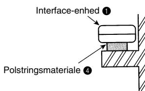
Ved montering af interface-enheten ① inde i et loft eller en væg, skal der installeres en adgangssluge for at muliggøre vedligeholdelse.
