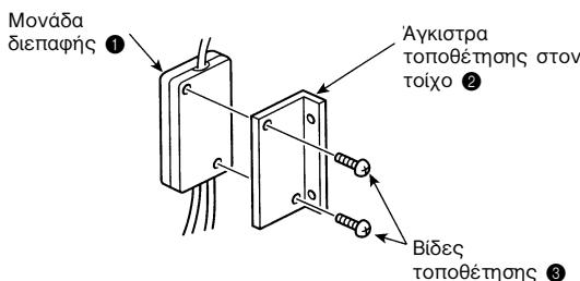
**2** Τοποθετήστε τη μονάδα πάνω σε μια κολώνα ή τοίχο χρησιμοποιώντας 2 βίδες τοποθέτησης ③.
