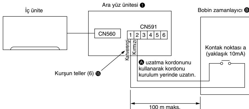
\* Kontak noktası açıldığında ünite kapanacak ve uzaktan kumandanın çalıştırılmayacaktır.
