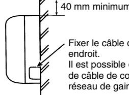
Fixer le câble de connexion de l'interface ① à cet endroit.
