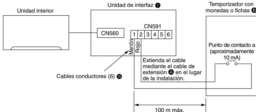
\* Cuando se abre el punto de contacto, se apagará la unidad y no podrá ponerse en funcionamiento desde el control remoto. Cuando se cierra el punto de contacto, se encenderá la unidad y podrá ponerse en funcionamiento con el control remoto.
