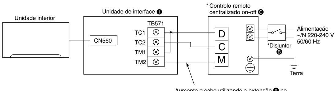
\* Consulte o manual de instalação do controlo remoto centralizado on-off.
