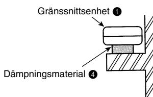
När gränssnittsenheten ① monteras i ett tak eller en vägg ska en åtkomstlucka tillhandahållas för att underlätta underhåll.
