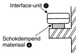
Als u de interface-unit ① in een plafond of muur monteert, dient u een toegangsdeur te installeren om onderhoudswerk te vergemakkelijken.
