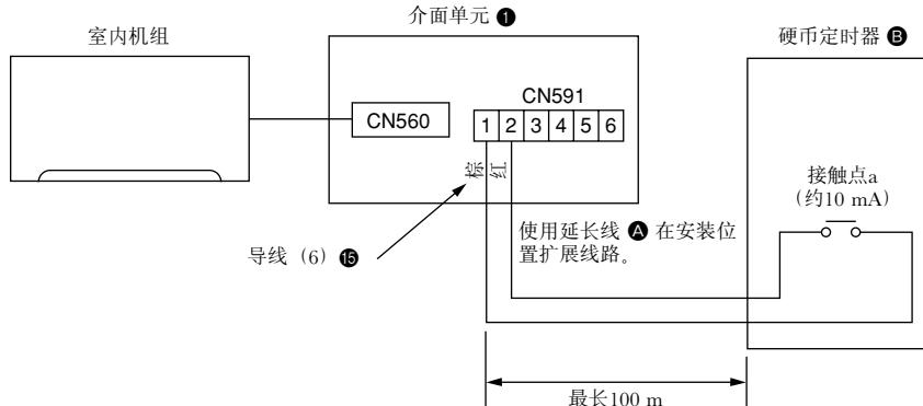
\* 当接触点打开后，单元将关闭并无法用遥控器操作。
