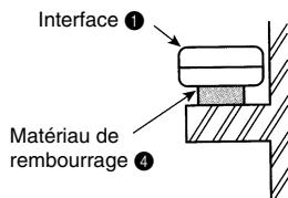
Lors de la fixation de l'interface ① dans un plafond ou un mur, veillez à installer une porte/trappe d'accès pour faciliter toute intervention d'entretien.
