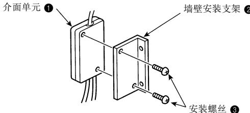
2 使用2个安装螺丝 ③ 将单元安装到柱子或墙壁上。
