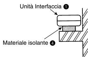
Quando si monta l'unità interfaccia ① incassata nel soffitto o in una parete, installare uno sportello di accesso per agevolare la manutenzione.
