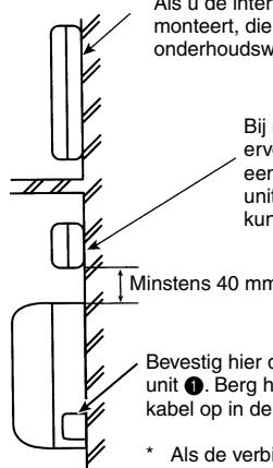
Bij montage boven een binnenuit dient u ervoor te zorgen dat de interface-unit ① op een afstand van minstens 40 mm van de unit wordt geplaatst, zodat plafondroosters kunnen worden verwijderd.
