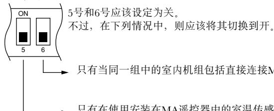
只有当同一组中的室内机组包括直接连接MA遥控器和室内机组的机型时，才将其切换为开。
