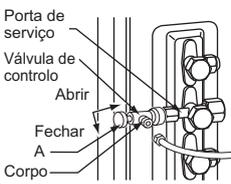
Quando instalar a válvula de controlo na porta de serviço, a chapeleta da válvula pode deformar-se ou afrouxar se for aplicada demasiada pressão. Isto pode provocar fuga de gás.
