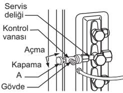
**Kontrol vanasını servis deliğine takarken, aşırı basınç uygulanırsa vana çekirdeği deforme olur veya gevşer. Bu gaz sızıntısına yol açabilir.**
