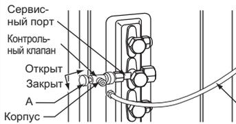
Если при креплении контрольного клапана к сервисному порту прилагать чрезмерное давление, сердечник клапана может деформироваться или открыться. Это может привести к утечке газа.
