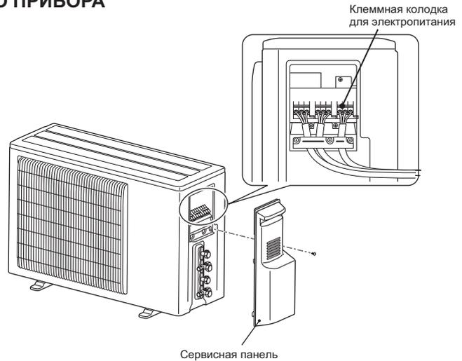
Провод соединения внутреннего/наружного приборов
