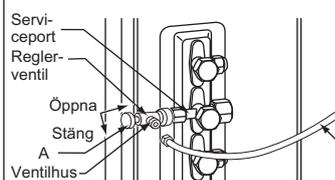
Vid anslutning av reglerventilen till serviceporten kan ventilinsatsen deformeras eller lossna om för högt tryck ansätts. Detta kan orsaka gasläckage.
