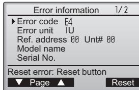
Wyświetlone zostaną (Error code): kod błędu (Error unit), adres układu chłodzącego (Ref. address), nazwa modelu urządzenia (Model name), oraz numer seryjny (Serial No.).
