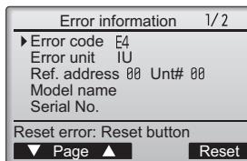
Zobrazí se kód chyby (Error code), chybová jednotka (Error unit), adresa chladiva (Ref. address), název modelu (Model name) jednotky a sériové číslo (Serial No.).
