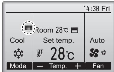
se zobrazí v hlavním zobrazení v režimu Úplné, až nastane čas na vyčištění filtrů.
