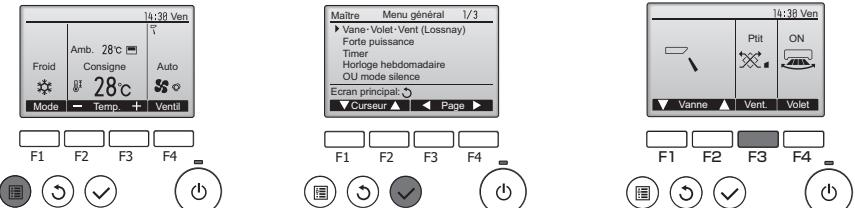
Le ventilateur d'un appareil d'intérieur peut fonctionner même lorsque l'appareil de ventilation est utilisé individuellement, selon les modèles d'appareil intérieur et d'appareil de ventilation.
