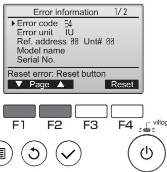
Hiba kód (Error code), Hibás egység (Error unit), Hűtőközeg cím (Ref. address), Egység modellszáma (Model name), És sorozatszám jelenik meg. (Serial No.)
