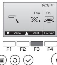
Ventilátor vnútorej jednotky môže fungovať aj keď ventilačná jednotka funguje samostatne, v závislosti od modelov vnútorej a ventilačnej jednotky.
