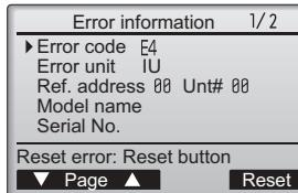
Se va afișa cod de eroare (Error code), unitatea eroare (Error unit), adresă de răcire (Ref. address), denumirea modelului unității (Model name) și numărul serial (Serial No.).
