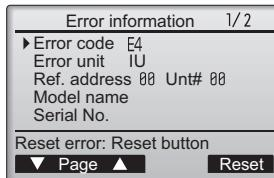
Foutcode (Error code), fout-unit (Error unit), koelmiddeladres (Ref. address), modelnaam van unit (Model name) en serienummer (Serial No.) verschijnen.
