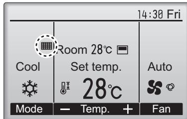
prikazat će se na glavnom zaslonu u načinu rada cijelo kada dođe vrijeme za čišćenje filtra.
