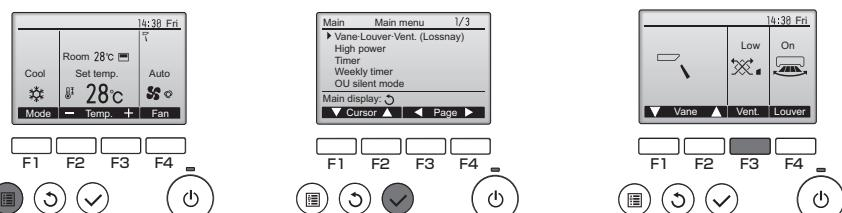
Wentylator jednostki wewnętrznej można działać nawet w przypadku, gdy sterowanie jednostką wentylacyjną odbywa się indywidualnie. Jest to zależne od modelu jednostki wewnętrznej i jednostki wentylacyjnej.
