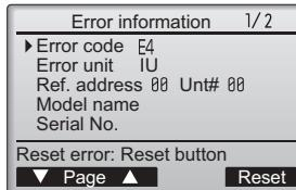
Fejlkode (Error code), fejlenhed (Error unit), kølemiddeladresse (Ref. address), enhedens modelnavn (Model name) og serienummer vises (Serial No.).
