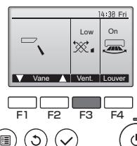
A beltéri egység ventilátora akkor is működhet, ha a szellőztető egységet különállón működteti, független a beltéri egység és a szellőztető egység típusától.
