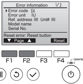
Извеждат се код на грешка (Error code), уред, даващ грешка (Error unit), адрес на охладителното тяло (Ref. address), наименование на модела на тялото (Model name) и сериен номер (Serial No.).
