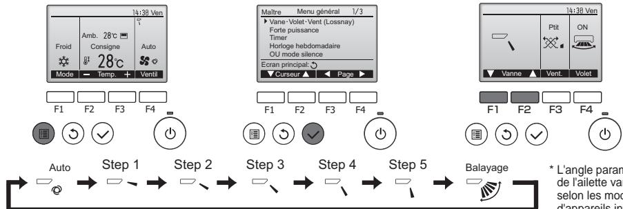
\* L'angle paramétrable de l'ailette varie selon les modèles d'appareils intérieurs.
