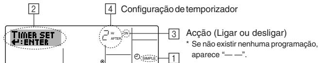
1. Certifique-se de que o mostrador é um mostrador inicial de controlo e que aparece o indicador de temporizador simples (em ①). Quando aparece uma indicação diferente de Simple Timer (Temporizador Simples), active SIMPLE TIMER utilizando a selecção de função (consulte 8.[4]–3 (3)) da programação da função de temporizador.
