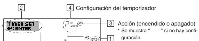
1. Asegúrese de que se encuentra en una pantalla de control estándar y de que el indicador de temporizador simple se muestra en la pantalla (en ①). Cuando aparezca una indicación distinta de la del temporizador simple, cámbielo a SIMPLE TIMER (TEMPORIZADOR SIMPLE) utilizando la selección de funciones de la configuración de funciones del temporizador del mando a distancia (véase 8.[4]-3 (3)).
