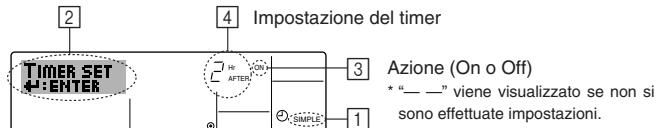
1. Assicurarsi che sia visualizzata la schermata di controllo standard e che l'indicatore corrispondente al timer semplice ① sia visualizzato sul display. Se il display visualizza informazioni diverse da Simple Timer, impostare su SIMPLE TIMER utilizzando la selezione delle funzioni (vedi 8.[4]–3 (3)) per l'impostazione della funzione timer.
