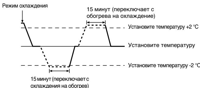
■ Из-за того, что температура в помещении автоматически настраивается для поддержания фиксированной оптимальной температуры, работа в режиме охлаждения выполняется на несколько градусов теплее, а работа в режиме обогрева работает на несколько градусов холоднее, чем заданная температура при ее достижении (автоматическое энергосбережение).
