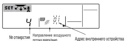
Переключите на адрес следующего устройства с помощью кнопки установки температуры ⑥.
