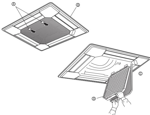
① Den Knopf am Ansauggitter in der durch den Pfeil gekennzeichneten Richtung ziehen und das Gitter sollte sich öffnen.
