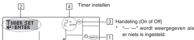
1. Zorg dat u het standaard bedieningsscherm voor u hebt en dat de indicator van de enkelvoudige timer ① op het display wordt weergegeven. Als niet de enkelvoudige timer wordt weergegeven, maar iets anders, stelt u de SIMPLE TIMER in via Function Selection (zie 8.[3] (3)) timerfunctie inschakelen.
