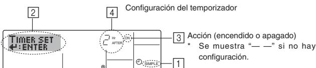
1. Asegúrese de que se encuentra en una pantalla de control estándar y de que el indicador de temporizador simple se muestra en la pantalla (en ①). Cuando aparezca una indicación distinta de la del temporizador simple, cámbielo a SIMPLE TIMER (TEMPORIZADOR SIMPLE) utilizando la selección n de funciones del temporizador del mando a distancia (véase 8.[3] (3)).
