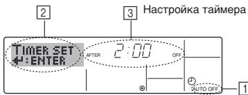
1. Убедитесь, что отображается стандартный экран управления и индикатор таймера отключения (Auto Off) (1).
