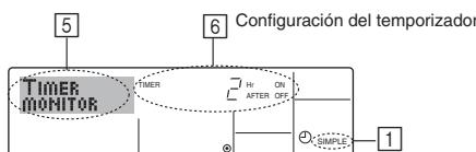
1. Asegúrese de que el indicador del temporizador simple está visible en la pantalla (en ①).
