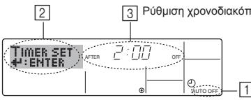
1. Βεβαιωθείτε ότι βρίσκετε σε τυπική οθόνη ελέγχου και εμφανίζεται ο δείκτης χρονοδιακόπτη αυτόματης διακοπής στην ένδειξη (στο ①).
