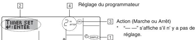
1. Assurez-vous que vous êtes sur un écran de contrôle standard, et que le témoin du programmeur simple s'affiche (en ①). Lorsque qu'une fonction autre que le temporisateur simple est affichée, réglez la télécommande sur SIMPLE TIMER en utilisant le paramètre de fonction temporisateur de la sélection des fonctions (voir 8.[3] (3)).
