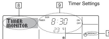
1. Kontroller at indikatoren for den ugentlige tidsmåler vises på displayet (i ①).
