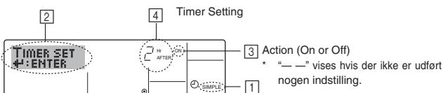
1. Kontroller at man er i displayet til standardstyring og at indikatoren for den enkle tidsmåler er vist i displayet (i ①).
