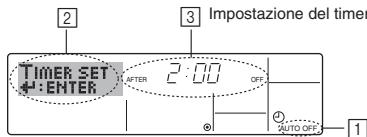
1. Assicurarsi che sia visualizzata la schermata di controllo standard e che l'indicatore corrispondente al timer di arresto automatico ① sia visualizzato sul display.
