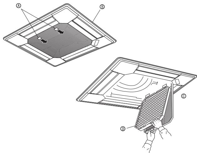
① Tirer le bouton de la grille d'aspiration dans le sens indiqué par la flèche pour ouvrir la grille.
