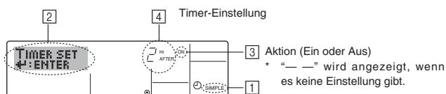
1. Achten Sie darauf, daß Sie sich im Standardkontrollbildschirm befinden und daß die Anzeige des einfachen Timers auf dem Display angezeigt wird (unter ①).
