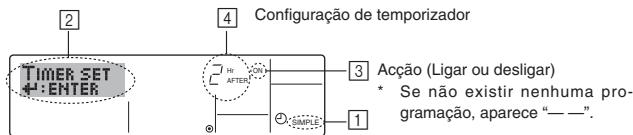
1. Certifique-se de que o mostrador é um mostrador inicial de controlo e que aparece o indicador de temporizador simples (em ①). Quando aparece uma indicação diferente de Simple Timer (Temporizador Simples), active SIMPLE TIMER utilizando a selecção de função (consulte 8.[3] (3)) da programação da função de temporizador.
