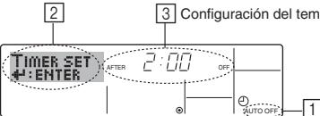
1. Asegúrese de que usted se encuentre en una pantalla de control estándar y que el indicador del temporizador de apagado automático Auto Off se muestre en la pantalla (en ①).
