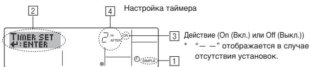
1. Убедитесь, что отображается стандартный экран управления, а также индикатор простого таймера (①).
