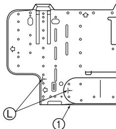
②-② Levez l'appareil intérieur en accrochant la pièce de support (sur la planche d'installation) aux saillies situées au dos de l'appareil comme l'indique. Lorsque la tuyauterie etc est installée, remplacez la pièce de support sur la planche d'installation.
