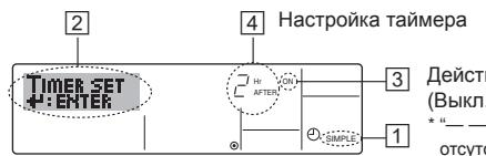
1. Убедитесь, что отображается стандартный экран управления, а также индикатор простого таймера (1).
