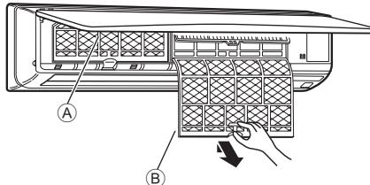
① Двумя руками потяните оба нижних угла воздухозаборной решетки, чтобы открыть ее, затем поднимите фильтр до его фиксации в положении остановки.
