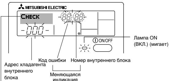
В случае возникновения проблемы, если был введен контактный номер, на дисплее будет отображен этот номер. (Его можно установить с помощью выбора функций на пульте дистанционного управления. Информацию смотри в руководстве по установке.)
