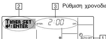
1. Βεβαιωθείτε ότι βρίσκεστε σε τυπική οθόνη ελέγχου και εμφανίζεται ο δείκτης χρονοδιακόπτη αυτόματης διακοπής στην ένδειξη (στο ①). Όταν εμφανίζεται ένδειξη διαφορετική του χρονοδιακόπτη αυτόματης διακοπής, ρυθμίστε την στο AUTO OFF TIMER χρησιμοποιώντας τη ρύθμιση λειτουργίας χρονοδιακόπτη του τηλεχειριστήριου (βλέπε εγχειρίδιο εγκατάστασης).
