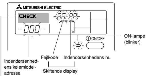
Hvis du har indtastet et kontaktnummer, der skal kaldes op til i tilfælde af problemer, viser skærbilledet dette nummer. (Du kan indstille dette under Function Selection på fjernbetjeningen. Installationsvejledningen indeholder flere oplysninger.)
