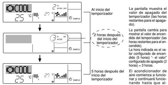
La pantalla muestra el valor de apagado del temporizador (las horas restantes para el apagado).
