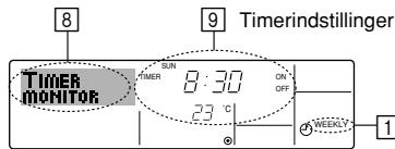
1. Kontrollér, at indikatoren for ugetimer vises på skærmbilledet (ved ①).
