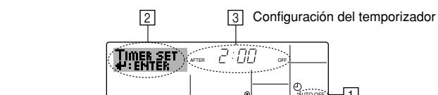
1. Asegúrese de que usted se encuentre en una pantalla de control estándar y que el indicador del temporizador de apagado automático se muestre en la pantalla (en ①).
