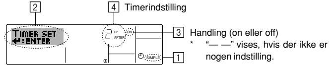
1. Sørg for, at standardskærmbilledet vises, og at indikatoren for simpel timer vises på displayet (ved ①).
