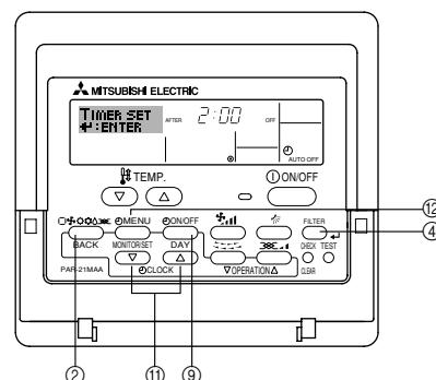
► Порядок установки таймера с автоматическим отключением
