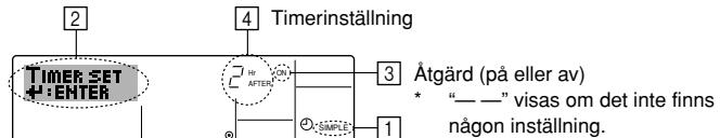
1. Försäkra att du visar standardkontrollsärmén och att indikatorn för enkel timer visas på displayen (vid ①). Om någonting annat än enkel timer visas ska du ställa in på ENKEL TIMER med fjärrkontrollen (Finns i installationshandboken) inställning av timer.
