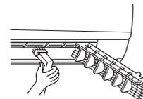
4. Setzen Sie die vertikalen Flügel nacheinander in deren ursprünglicher Lage in die jeweilige Führung ein.
