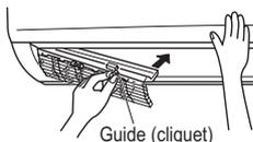
5. Remplacez les ailettes horizontales en suivant la procédure de dépose en sens inverse.
