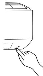
A chaque fois que vous appuyez sur l'interrupteur de secours (E.O.SW), le fonctionnement du climatiseur change dans l'ordre suivant :
