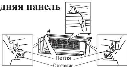
1. Поднимайте переднюю панель до тех пор, пока она не зафиксируется на месте со щелчком.
