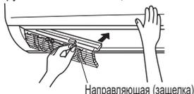
5. Устанавливайте горизонтальную заслонку, выполняя инструкции по ее снятию в обратном порядке.
