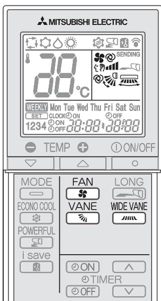
Premere **FAN** per selezionare la velocità del ventilatore. Ad ogni pressione del tasto, la velocità del ventilatore cambia nell'ordine seguente:
