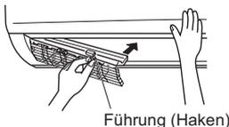
5. Installieren Sie den horizontalen Flügel in umgekehrter Reihenfolge des Ausbaus.
