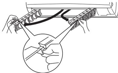
3. Reinigen Sie den Luftauslass und Ventilator.
