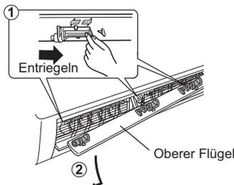
2. Schwenken Sie die beiden vertikalen Flügel einzeln heraus.
