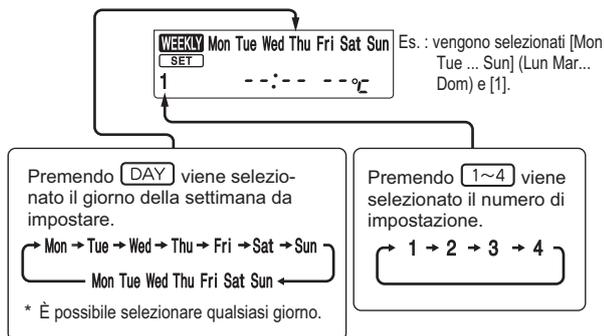
**3** Premere **ON/OFF**, **TIME** e **TEMP** per impostare ON/OFF (accensione/spegnimento), TIME (ora) e TEMPERATURE (temperatura).
