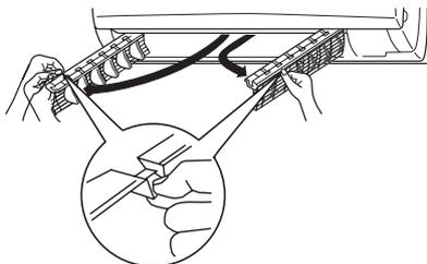
3. Rengør luftudblæsningen og ventilator.
