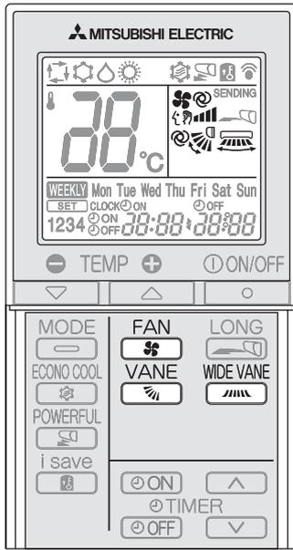
Wählen Sie mit
