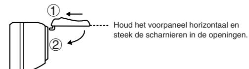
Houd het voorpaneel horizontaal en steek de scharnieren in de openingen.
