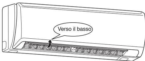
**2** Rimuovere l'aletta orizzontale. Mantenere saldamente l'aletta orizzontale nel momento in cui si sbloccano i fermi.
