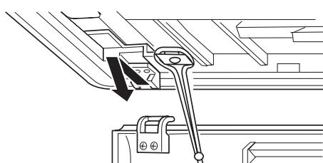
4. Reposez la grille d'admission en suivant la procédure de dépôse en sens inverse. Refermez correctement la grille d'admission et appuyez sur les repères indiqués par les flèches.
