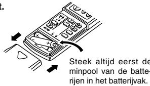
Steek altijd eerst de minpool van de batterijen in het batterijvak.
