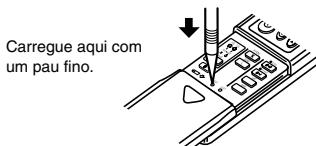
• Se o botão de reposição em zero não for premido, o controlo remoto pode não funcionar correctamente.
