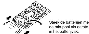
Steek de batterijen met de min-pool als eerste in het batterijvak.
