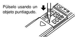
**4 Pulse los botones HR. y MIN. (botones de ajuste de la hora) para poner el reloj en hora.**
